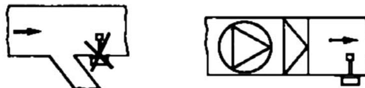
Filter bzw. Kühler beruhigen die Strömung.
