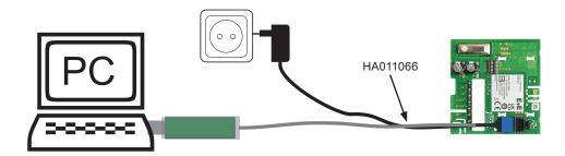
Fig. 1 CDS201 configuration setup
