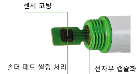
센서 코팅 및 언더필(Underfill) 처리된 센싱 헤드
